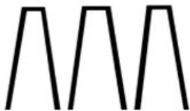
Alarm bei Feuer und anderen Notständen, der zur Alarmierung der Einsatzkräfte der Feuerwehren dient. Signal: Dreimal in der Höhe gleichbleibender Ton (Dauerton) von je zwölf Sekunden Dauer, mit je zwölf Sekunden Pause zwischen den Tönen.
